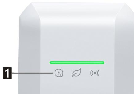
Se la corrente di ricarica viene limitata da una corrente di ricarica predefinita intelligente, si accende il simbolo Smart Charging. In questo caso, il limite della corrente di ricarica può essere annullato una volta per il ciclo di ricarica in corso utilizzando il Touch Button **(1)** (superficie a sfioramento), a condizione che l'operatore di rete lo consenta. Il veicolo in questo modo può essere ricaricato più rapidamente, se necessario.
