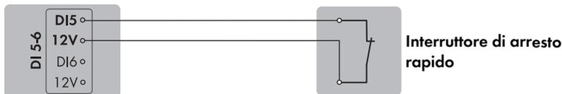
Figura 14: Collegamento di un interruttore per l'arresto rapido all'ingresso digitale DI 5 della stazione di ricarica che deve essere configurata come System Manager
