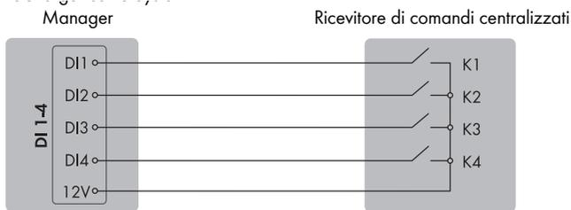
Figura 13: Collegamento di un ricevitore di comandi centralizzati all'ingresso digitale DI 1-4 dello SMA eCharger che deve essere configurato come System Manager
