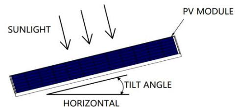
**Fig. 1 PV module tilt angle**
