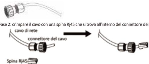
Fase 2: crimpare il cavo con una spina RJ45 che si trova all'interno del connettore del cavo.
