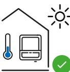
Montare l'inverter in una posizione riparata, ad es. al di sotto dei moduli solari o sotto una sporgenza del tetto.
