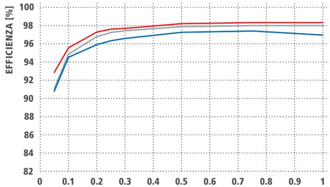
POTENZA DI USCITA STANDARDIZZATA  $P_{AC}/P_{AC,R}$  ■ 174 V<sub>DC</sub> ■ 610 V<sub>DC</sub> ■ 800 V<sub>DC</sub>
