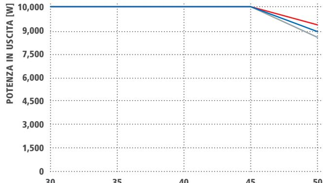
TEMPERATURA DELL'AMBIENTE [°C] ■ 278 V<sub>DC</sub> ■ 610 V<sub>DC</sub> ■ 800 V<sub>DC</sub>
