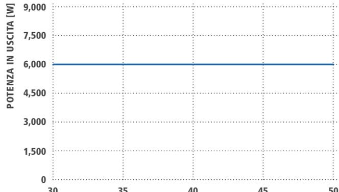
TEMPERATURA DELL'AMBIENTE [°C] ■ 174 V<sub>DC</sub> ■ 610 V<sub>DC</sub> ■ 800 V<sub>DC</sub>
