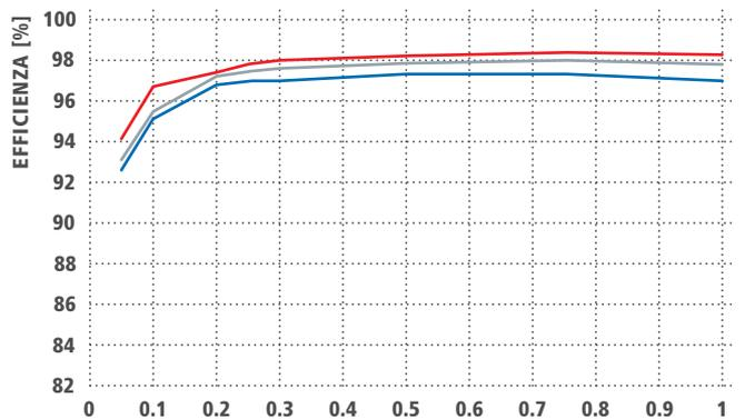
POTENZA DI USCITA STANDARDIZZATA  $P_{AC}/P_{AC,R}$  ■ 224 V<sub>DC</sub> ■ 610 V<sub>DC</sub> ■ 800 V<sub>DC</sub>
