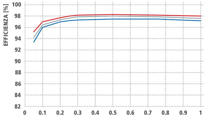
POTENZA DI USCITA STANDARDIZZATA  $P_{AC}/P_{AC,R}$  ■ 278 V<sub>DC</sub> ■ 610 V<sub>DC</sub> ■ 800 V<sub>DC</sub>
