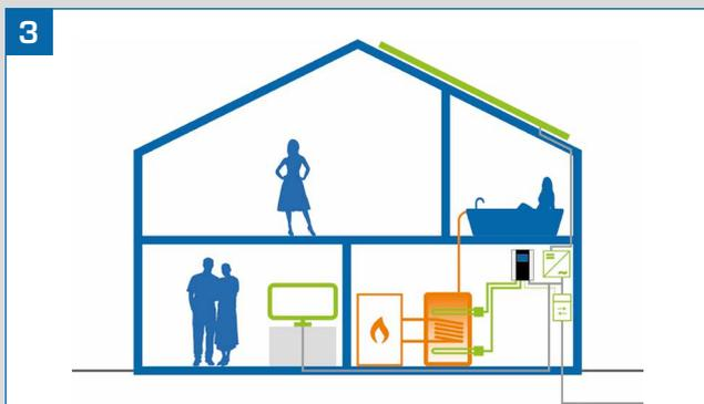
Gestione di due resistenze all'interno dello stesso boiler
